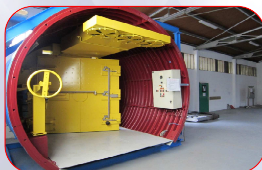
Porte d'intertube – Tunnel sous La Manche
