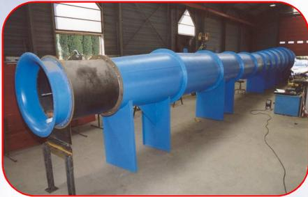
Tunnel d'essai pour ventilateurs
