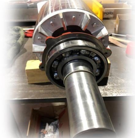
Remplacement des roulements et graissage
